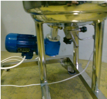
DETALJI: MAGNETNA MEŠALICA I MEMBRANSKI VENTIL
